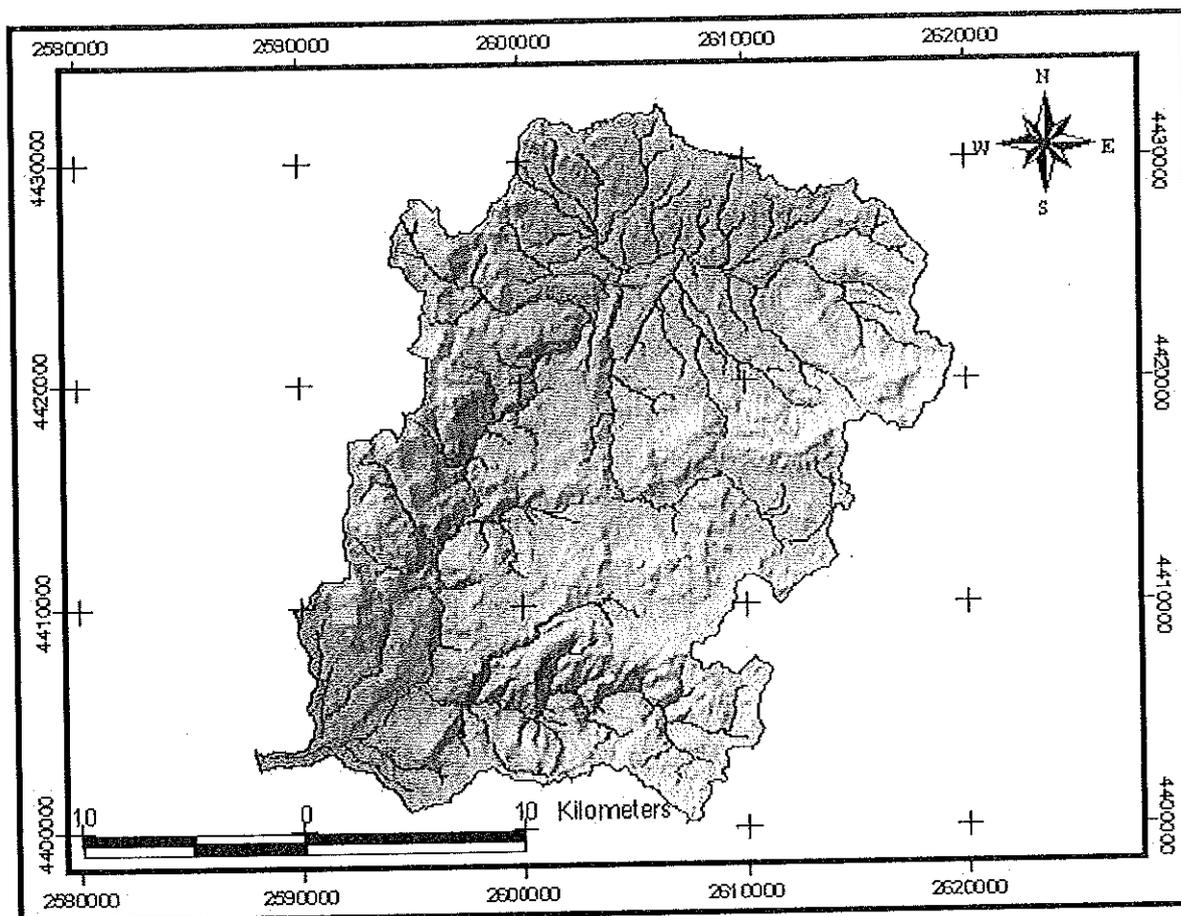
Il bacino del fiume Lao ha una estensione planimetrica complessiva di 595.93 km<sup>2</sup>, con sezione di chiusura coincidente con la foce del Mar Tirreno. Il perimetro dell'intero spartiacque è pari a 144.71 km e la lunghezza della sua asta principale è di circa 48.68 km con una pendenza media dell'1.9%. Il valore della densità di drenaggio<sup>2</sup> è 2.91 km/km<sup>2</sup>. La forma risulta ovale allungata, evidenziata da un coefficiente di forma (Gravelius)<sup>3</sup> pari a 1.67
